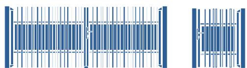
Portail battant avec tôle décorative en acier installée entre les deux lisses pour une occultation partielle    Portail battant 1 vantail
