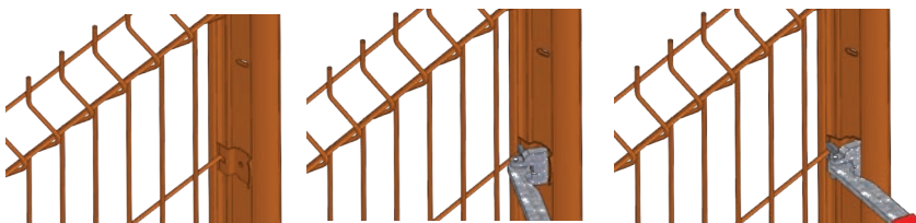
Montage du Clips avec le Clipseur AQUILON®
